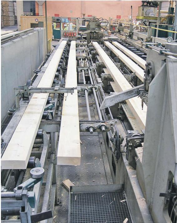
In der Zugprüfanlage von Hasslacher Norica Timber werden die Leimholz-Träger GLT® einzeln überprüft
